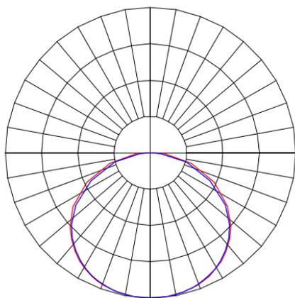
Luminária quadrada de embutir em forro modulado, 40W 4000K IRC>80. Corpo em alumínio. Acabamento Branca, Preta ou Especial. Controle óptico principal através de difusor em poliestireno translúcido. Luminária grau de proteção IP-20. Driver corrente constante Liga/Desliga, Triac, 1-10V ou Dali (consultar condições). Tensão de trabalho 220V ou Bivolt.
