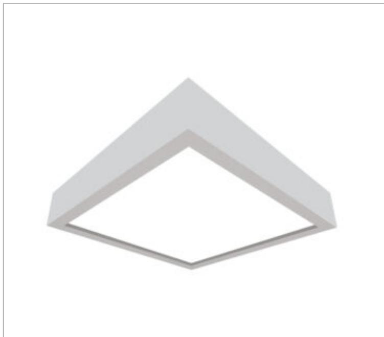
Luminária quadrada de sobrepor, 20W 4000K IRC>80. Corpo em alumínio. Acabamento Branca, Preta ou Especial. Controle óptico principal através de difusor em poliestireno translúcido. Luminária grau de proteção IP-20. Driver corrente constante Liga/Desliga Tensão de trabalho 220V ou Bivolt.
