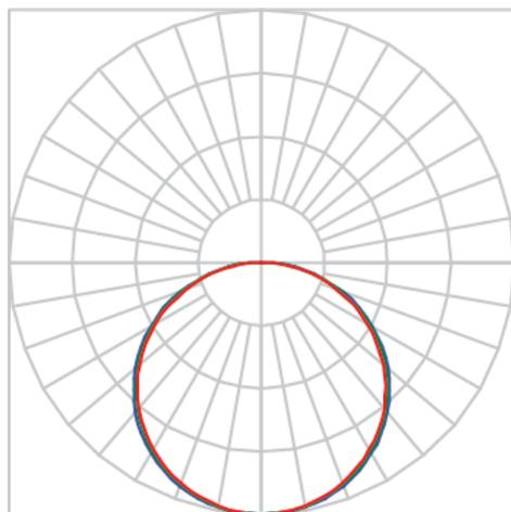
Luminária quadrada de sobrepor, 34W 3000K IRC>80. Corpo em alumínio. Acabamento Branca, Preta ou Especial. Controle óptico principal através de difusor em poliestireno translúcido. Luminária grau de proteção IP-20. Driver corrente constante Liga/Desliga, Triac, 1-10V ou Dali (consultar condições). Tensão de trabalho 220V ou Bivolt.
