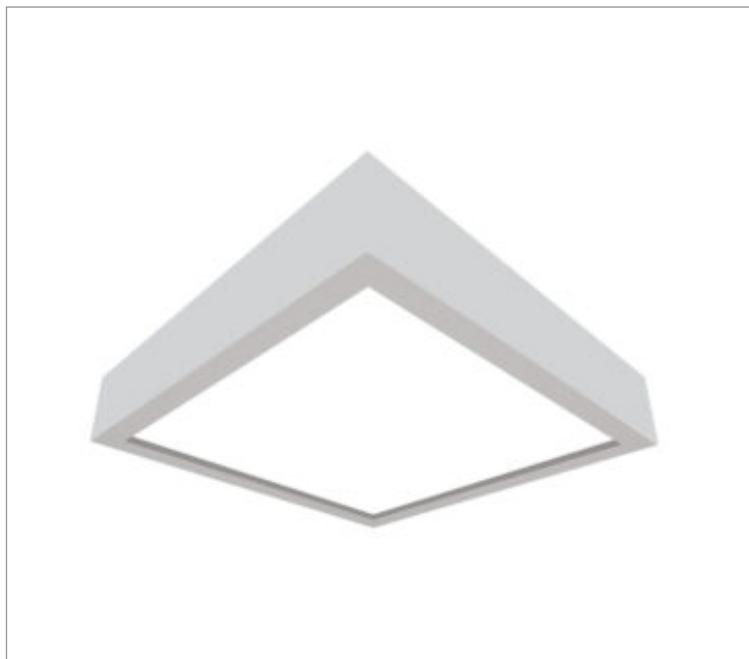
Luminária quadrada de sobrepor, 56W 2700K IRC>95. Corpo em alumínio. Acabamento Branca, Preta ou Especial. Controle óptico principal através de difusor em poliestireno translúcido. Luminária grau de proteção IP-20. Driver corrente constante Liga/Desliga Tensão de trabalho 220V ou Bivolt.
