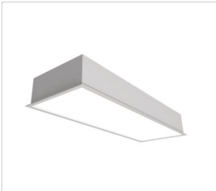
Luminária retangular de embutir em forro de gesso, 56W 4000K IRC>95. Corpo em alumínio. Acabamento Branca, Preta ou Especial. Controle óptico principal através de difusor em poliestireno translúcido. Luminária grau de proteção IP-20. Driver corrente constante Liga/Desliga Tensão de trabalho 220V ou Bivolt.
