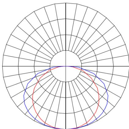
Luminária retangular de embutir em forro modulado, 34W 3000K IRC>80. Corpo em alumínio. Acabamento Branca, Preta ou Especial. Controle óptico principal através de difusor em poliestireno translúcido. Luminária grau de proteção IP-20. Driver corrente constante Liga/Desliga, Triac, 1-10V ou Dali (consultar condições). Tensão de trabalho 220V ou Bivolt.
