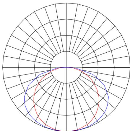
Luminária retangular de embutir em forro modulado, 34W 4000K IRC>80. Corpo em alumínio. Acabamento Branca, Preta ou Especial. Controle óptico principal através de difusor em poliestireno translúcido. Luminária grau de proteção IP-20. Driver corrente constante Liga/Desliga, Triac, 1-10V ou Dali (consultar condições). Tensão de trabalho 220V ou Bivolt.
