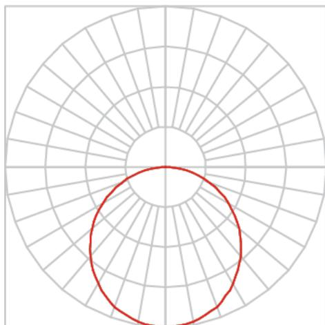
Luminária retangular de sobrepor, 20W 4000K IRC>80. Corpo em alumínio. Acabamento Branca, Preta ou Especial. Controle óptico principal através de difusor em poliestireno translúcido. Luminária grau de proteção IP-20. Driver corrente constante Liga/Desliga, Triac, 1-10V ou Dali (consultar condições). Tensão de trabalho 220V ou Bivolt.
