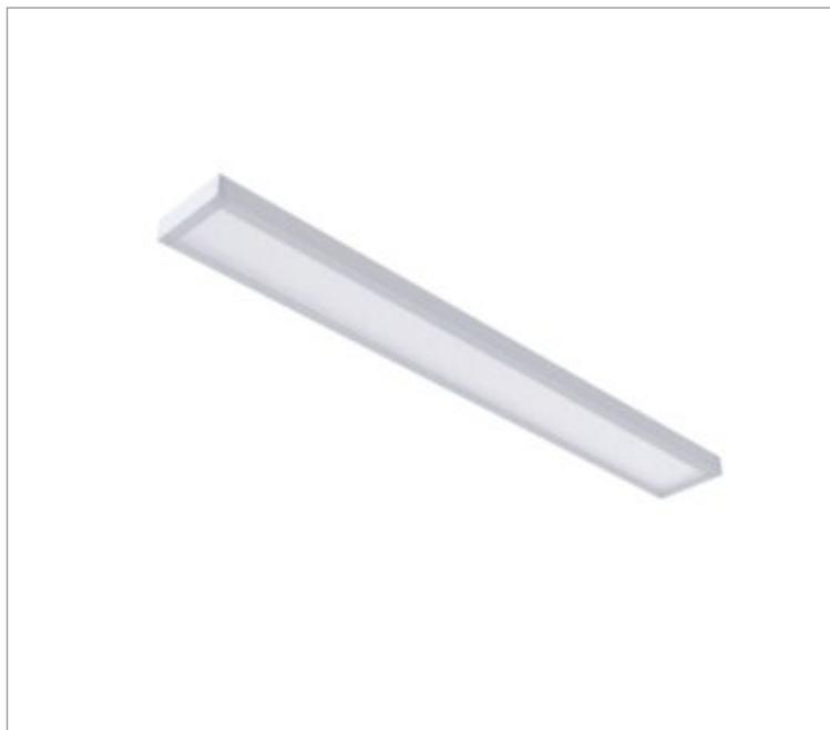
Luminária retangular de sobrepor, 20W 3000K IRC>95. Corpo em alumínio. Acabamento Branca, Preta ou Especial. Controle óptico principal através de difusor em poliestireno translúcido. Luminária grau de proteção IP-20. Driver corrente constante Liga/Desliga Tensão de trabalho 220V ou Bivolt.
