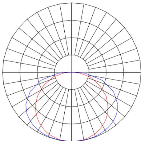
Luminária retangular de sobrepor, 34W 4000K IRC>80. Corpo em alumínio. Acabamento Branca, Preta ou Especial. Controle óptico principal através de difusor em poliestireno translúcido. Luminária grau de proteção IP-20. Driver corrente constante Liga/Desliga, Triac, 1-10V ou Dali (consultar condições). Tensão de trabalho 220V ou Bivolt.
