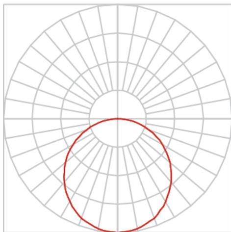
Luminária retangular de sobrepor, 40W 4000K IRC>80. Corpo em alumínio. Acabamento Branca, Preta ou Especial. Controle óptico principal através de difusor em poliestireno translúcido. Luminária grau de proteção IP-20. Driver corrente constante Liga/Desliga, Triac, 1-10V ou Dali (consultar condições). Tensão de trabalho 220V ou Bivolt.
