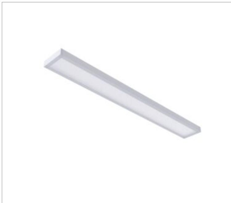
Luminária retangular de sobrepor, 40W 4000K IRC>95. Corpo em alumínio. Acabamento Branca, Preta ou Especial. Controle óptico principal através de difusor em poliestireno translúcido. Luminária grau de proteção IP-20. Driver corrente constante Liga/Desliga Tensão de trabalho 220V ou Bivolt.
