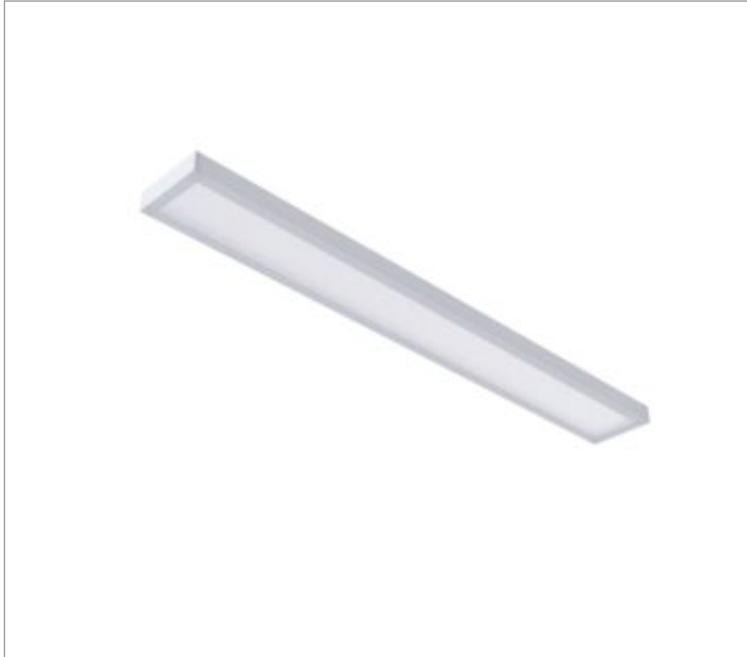
Luminária retangular de sobrepor, 56W 3000K IRC>80. Corpo em alumínio. Acabamento Branca, Preta ou Especial. Controle óptico principal através de difusor em poliestireno translúcido. Luminária grau de proteção IP-20. Driver corrente constante Liga/Desliga Tensão de trabalho 220V ou Bivolt.
