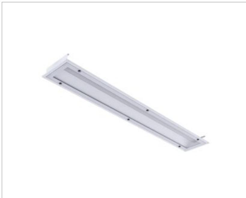
Luminária retangular de embutir em forro modulado, 20W 3000K IRC>80. Corpo em alumínio. Acabamento Branca, Preta ou Especial. Controle óptico principal através de facho difuso. Luminária grau de proteção IP-20. Driver corrente constante Liga/Desliga, Triac, 1-10V ou Dali (consultar condições). Tensão de trabalho 220V ou Bivolt.
