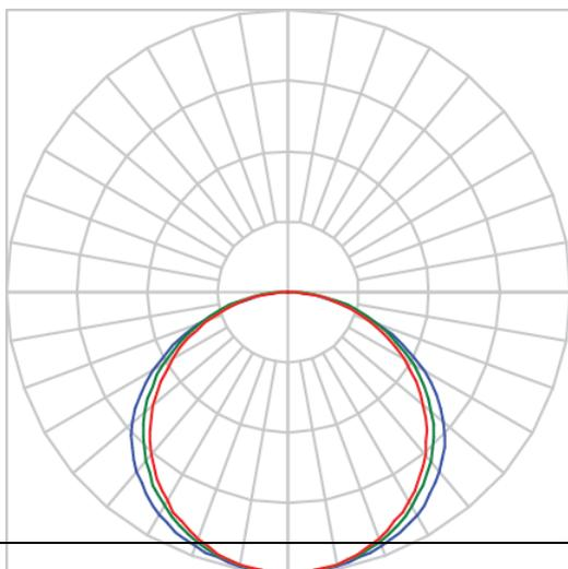
Luminária retangular de embutir em forro modulado, 20W 4000K IRC>80. Corpo em alumínio. Acabamento Branca, Preta ou Especial. Controle óptico principal através de facho difuso. Luminária grau de proteção IP-20. Driver corrente constante Liga/Desliga, Triac, 1-10V ou Dali (consultar condições). Tensão de trabalho 220V ou Bivolt.
