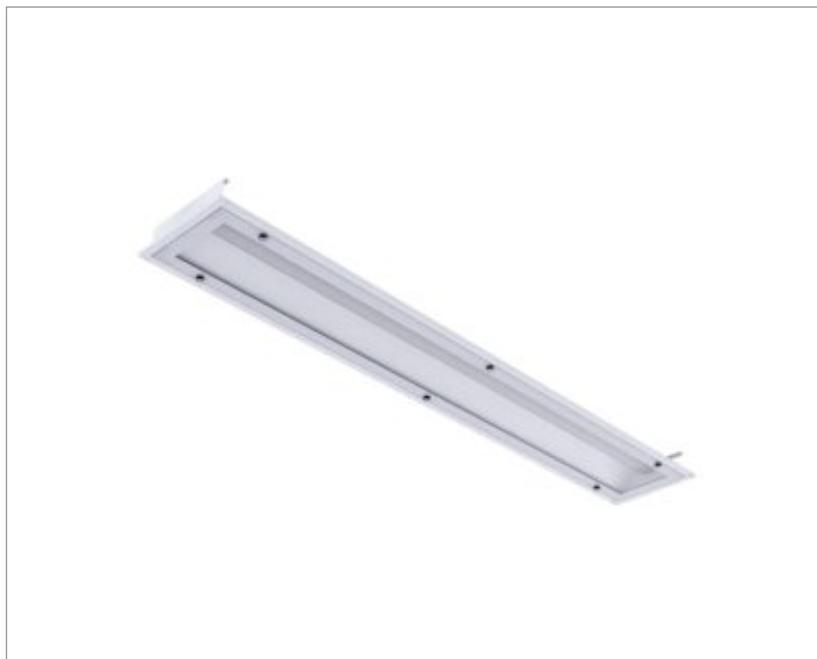
Luminária retangular de embutir em forro modulado, 56W 5000K IRC>95. Corpo em alumínio. Acabamento Branca, Preta ou Especial. Controle óptico principal através de facho difuso. Luminária grau de proteção IP-20. Driver corrente constante Liga/Desliga, Triac, 1-10V ou Dali (consultar condições). Tensão de trabalho 220V ou Bivolt.
