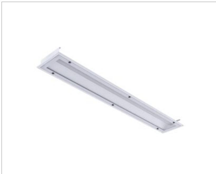
Luminária retangular de embutir em forro modulado, 56W 3000K IRC>80. Corpo em alumínio. Acabamento Branca, Preta ou Especial. Controle óptico principal através de facho difuso. Luminária grau de proteção IP-20. Driver corrente constante Liga/Desliga, Triac, 1-10V ou Dali (consultar condições). Tensão de trabalho 220V ou Bivolt.
