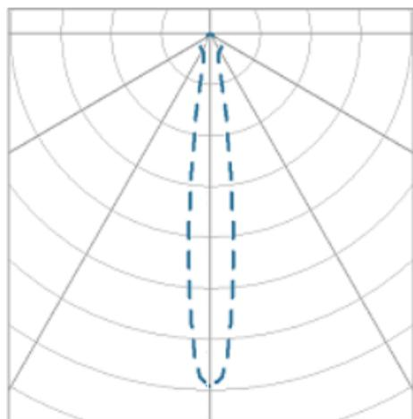
Luminária circular de embutir em forro de gesso, 14W 2500K IRC>95. Corpo em alumínio. Acabamento Branca, Preta ou Especial. Controle óptico principal através de refletor facho 15°. Luminária grau de proteção IP-20. Driver corrente constante Liga/Desliga, Triac, 1-10V ou Dali (consultar condições). Tensão de trabalho 220V ou Bivolt.
