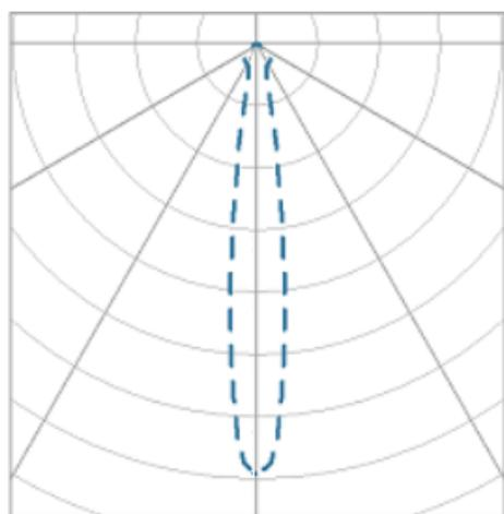
Luminária circular de embutir em forro de gesso, 14W 3000K IRC>95. Corpo em alumínio. Acabamento Branca, Preta ou Especial. Controle óptico principal através de refletor facho 15°. Luminária grau de proteção IP-20. Driver corrente constante Liga/Desliga, Triac, 1-10V ou Dali (consultar condições). Tensão de trabalho 220V ou Bivolt.
