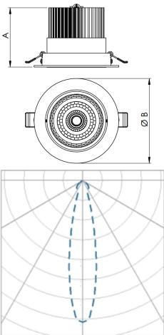
Luminária circular de embutir em forro de gesso, 20W 2500K IRC>95. Corpo em alumínio. Acabamento Branca, Preta ou Especial. Controle óptico principal através de refletor facho 15°. Luminária grau de proteção IP-20. Driver corrente constante Liga/Desliga, Triac, 1-10V ou Dali (consultar condições). Tensão de trabalho 220V ou Bivolt.
