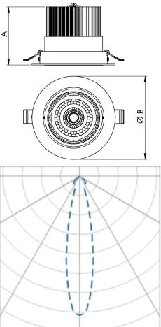
Luminária circular de embutir em forro de gesso, 28W 3000K IRC>90. Corpo em alumínio. Acabamento Branca, Preta ou Especial. Controle óptico principal através de refletor facho 15°. Luminária grau de proteção IP-20. Driver corrente constante Liga/Desliga, Triac, 1-10V ou Dali (consultar condições). Tensão de trabalho 220V ou Bivolt.
