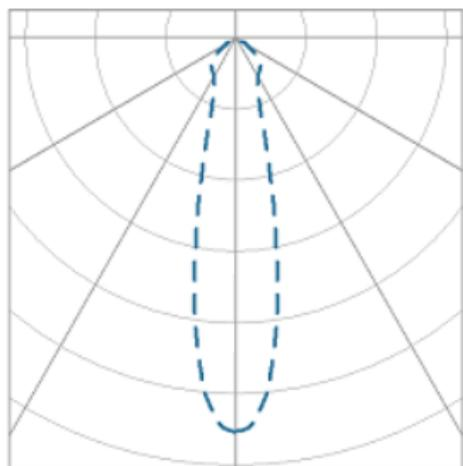
Luminária circular de embutir em forro de gesso, 10W 2700K IRC>90. Corpo em alumínio. Acabamento Branca, Preta ou Especial. Controle óptico principal através de refletor facho 24°. Luminária grau de proteção IP-20. Driver corrente constante Liga/Desliga, Triac, 1-10V ou Dali (consultar condições). Tensão de trabalho 220V ou Bivolt.
