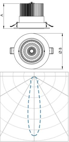
Luminária circular de embutir em forro de gesso, 7W 2700K IRC>90. Corpo em alumínio. Acabamento Branca, Preta ou Especial. Controle óptico principal através de refletor facho 24°. Luminária grau de proteção IP-20. Driver corrente constante Liga/Desliga, Triac, 1-10V ou Dali (consultar condições). Tensão de trabalho 220V ou Bivolt.
