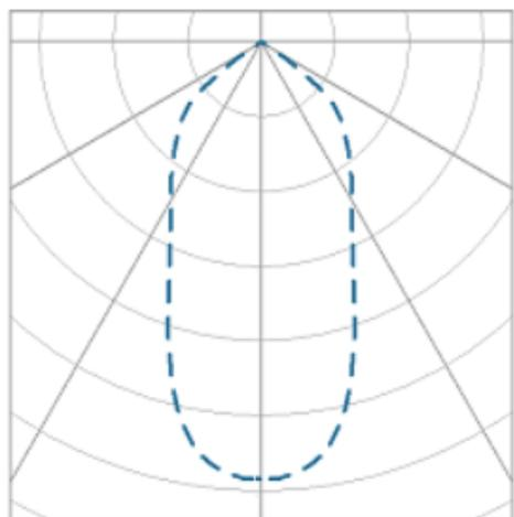
Luminária circular de embutir em forro de gesso, 14W 2700K IRC>90. Corpo em alumínio. Acabamento Branca, Preta ou Especial. Controle óptico principal através de refletor facho 36°. Luminária grau de proteção IP-20. Driver corrente constante Liga/Desliga, Triac, 1-10V ou Dali (consultar condições). Tensão de trabalho 220V ou Bivolt.
