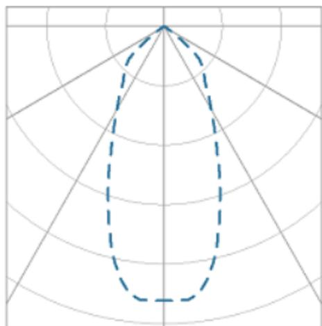
Luminária circular de embutir em forro de gesso, 20W 2700K IRC>90. Corpo em alumínio. Acabamento Branca, Preta ou Especial. Controle óptico principal através de refletor facho 36°. Luminária grau de proteção IP-20. Driver corrente constante Liga/Desliga, Triac, 1-10V ou Dali (consultar condições). Tensão de trabalho 220V ou Bivolt.
