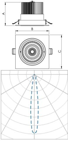
Luminária quadrada de embutir em forro de gesso, 10W 3000K IRC>95. Corpo em alumínio. Acabamento Branca, Preta ou Especial. Controle óptico principal através de refletor facho 15°. Luminária grau de proteção IP-20. Driver corrente constante Liga/Desliga, Triac, 1-10V ou Dali (consultar condições). Tensão de trabalho 220V ou Bivolt.
