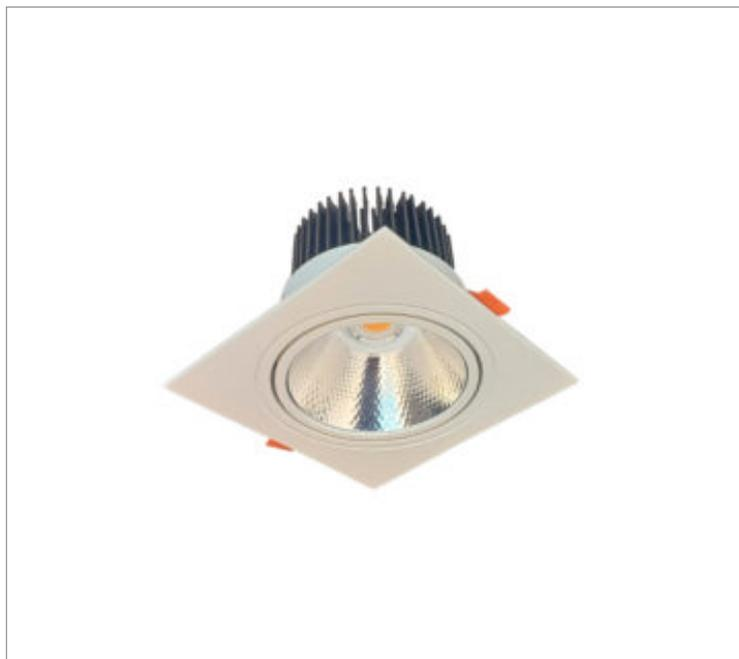
Luminária quadrada de embutir em forro de gesso, 14W 4000K IRC>90. Corpo em alumínio. Acabamento Branca, Preta ou Especial. Controle óptico principal através de refletor facho 15°. Luminária grau de proteção IP-20. Driver corrente constante Liga/Desliga, Triac, 1-10V ou Dali (consultar condições). Tensão de trabalho 220V ou Bivolt.
