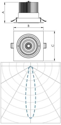
Luminária quadrada de embutir em forro de gesso, 28W 4000K IRC>90. Corpo em alumínio. Acabamento Branca, Preta ou Especial. Controle óptico principal através de refletor facho 15°. Luminária grau de proteção IP-20. Driver corrente constante Liga/Desliga, Triac, 1-10V ou Dali (consultar condições). Tensão de trabalho 220V ou Bivolt.
