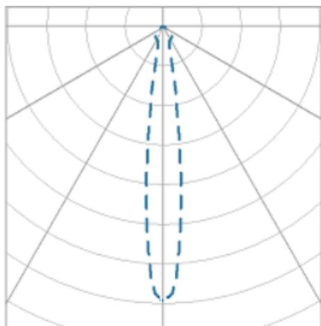
Luminária quadrada de embutir em forro de gesso, 7W 2700K IRC>90. Corpo em alumínio. Acabamento Branca, Preta ou Especial. Controle óptico principal através de refletor facho 15°. Luminária grau de proteção IP-20. Driver corrente constante Liga/Desliga, Triac, 1-10V ou Dali (consultar condições). Tensão de trabalho 220V ou Bivolt.
