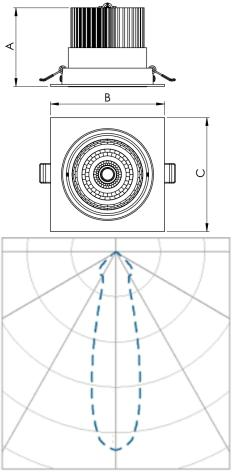
Luminária quadrada de embutir em forro de gesso, 28W 2700K IRC>90. Corpo em alumínio. Acabamento Branca, Preta ou Especial. Controle óptico principal através de refletor facho 24°. Luminária grau de proteção IP-20. Driver corrente constante Liga/Desliga, Triac, 1-10V ou Dali (consultar condições). Tensão de trabalho 220V ou Bivolt.
