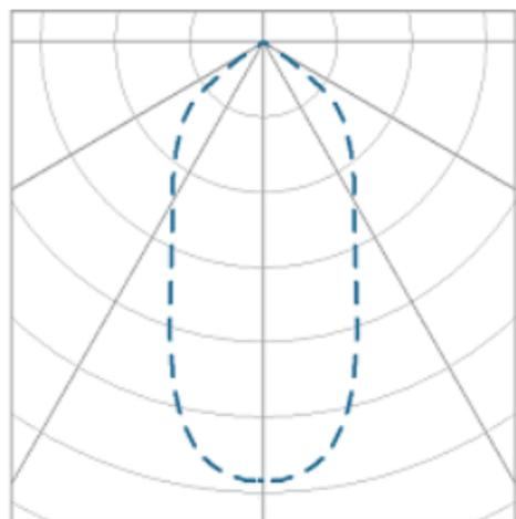
Luminária quadrada de embutir em forro de gesso, 7W 3000K IRC>90. Corpo em alumínio. Acabamento Branca, Preta ou Especial. Controle óptico principal através de refletor facho 36°. Luminária grau de proteção IP-20. Driver corrente constante Liga/Desliga, Triac, 1-10V ou Dali (consultar condições). Tensão de trabalho 220V ou Bivolt.
