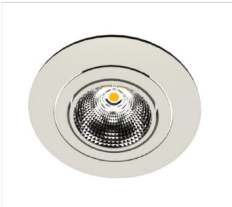
Luminária circular de embutir em forro de gesso, 20W 3000K IRC>95. Corpo em alumínio. Acabamento Branca, Preta ou Especial. Controle óptico principal através de refletor facho 60°. Luminária grau de proteção IP-20. Driver corrente constante Liga/Desliga, Triac, 1-10V ou Dali (consultar condições). Tensão de trabalho 220V ou Bivolt.
