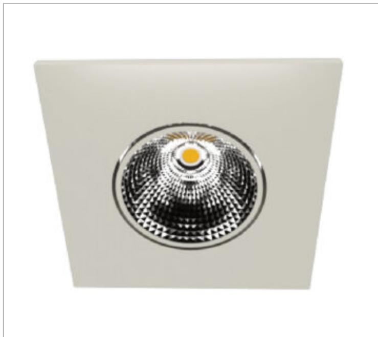
Luminária quadrada de embutir em forro de gesso, 28W 4000K IRC>80. Corpo em alumínio. Acabamento Branca, Preta ou Especial. Controle óptico principal através de refletor facho 60°. Luminária grau de proteção IP-20. Driver corrente constante Liga/Desliga, Triac, 1-10V ou Dali (consultar condições). Tensão de trabalho 220V ou Bivolt.
