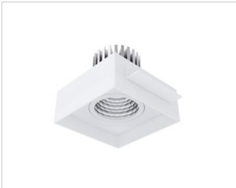
Luminária quadrada de embutir no-frame em forro de gesso, 14W 3000K IRC>95. Corpo em alumínio. Acabamento Branca, Preta ou Especial. Controle óptico principal através de refletor facho 60°. Luminária grau de proteção IP-20. Driver corrente constante Liga/Desliga, Triac, 1-10V ou Dali (consultar condições). Tensão de trabalho 220V ou Bivolt.
