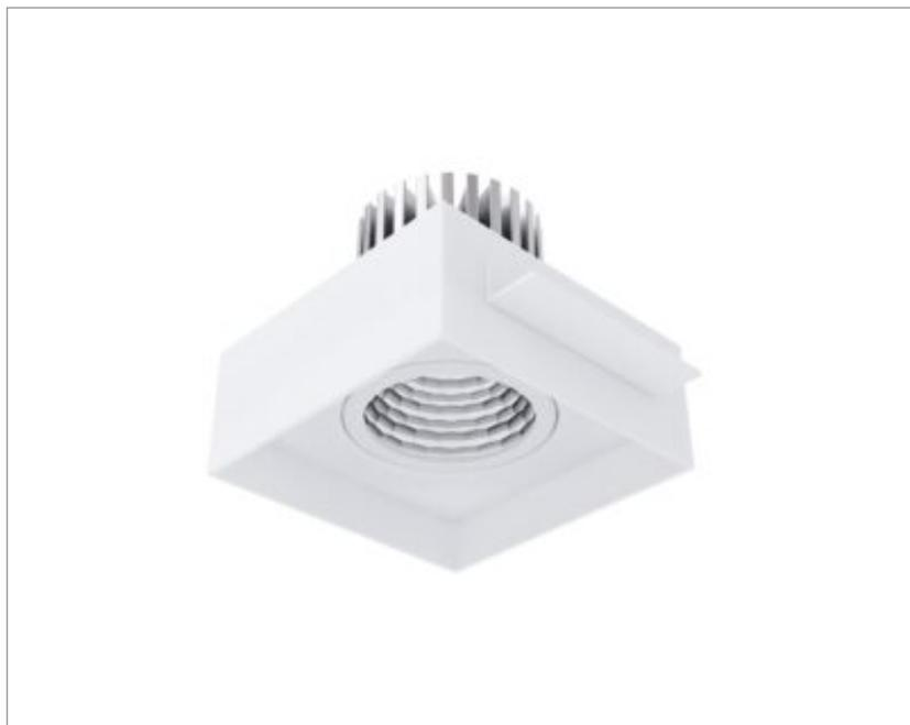
Luminária quadrada de embutir no-frame em forro de gesso, 7W 4000K IRC>80. Corpo em alumínio. Acabamento Branca, Preta ou Especial. Controle óptico principal através de refletor facho 60°. Luminária grau de proteção IP-20. Driver corrente constante Liga/Desliga, Triac, 1-10V ou Dali (consultar condições). Tensão de trabalho 220V ou Bivolt.
