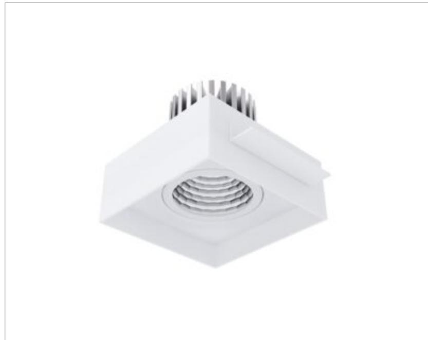
Luminária quadrada de embutir no-frame em forro de gesso, 7W 2500K IRC>95. Corpo em alumínio. Acabamento Branca, Preta ou Especial. Controle óptico principal através de refletor facho 60°. Luminária grau de proteção IP-20. Driver corrente constante Liga/Desliga, Triac, 1-10V ou Dali (consultar condições). Tensão de trabalho 220V ou Bivolt.
