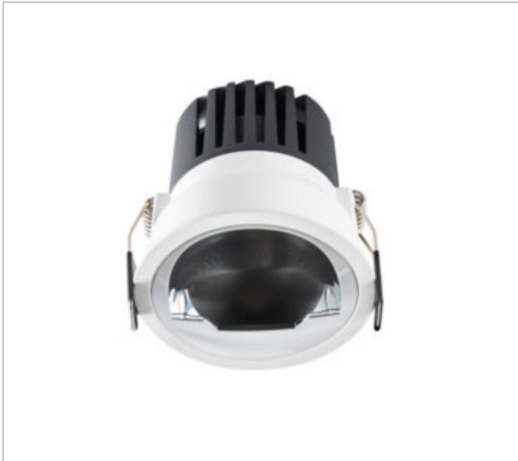
Luminária circular de embutir em forro de gesso, 15W 3000K IRC>90. Corpo em alumínio. Acabamento Branca. Controle óptico principal através de refletor fecho difuso. Luminária grau de proteção IP-20. Driver corrente constante Liga/Desliga, Triac, 1-10V ou Dali (consultar condições). Tensão de trabalho 220V ou Bivolt.
