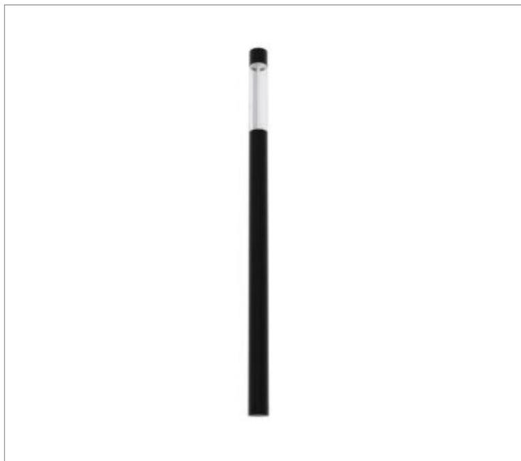
Pétala circular, 10W 5000K IRC>80. Corpo em alumínio. Acabamento Branca, Preta ou Especial. Controle óptico principal através de lente fecho assimétrico. Luminária grau de proteção IP-65. Driver corrente constante Liga/Desliga, Triac, 1-10V ou Dali (consultar condições). Tensão de trabalho 220V ou Bivolt.
