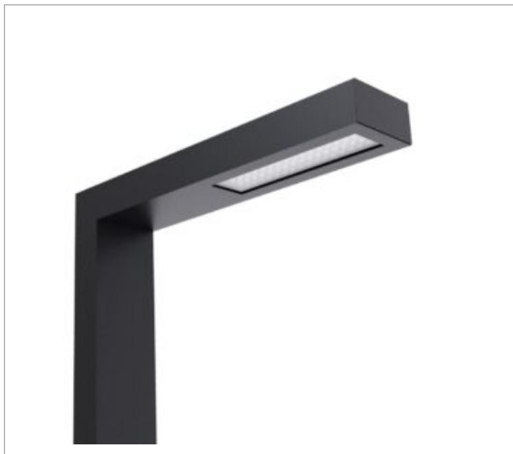
Pétala retangular, 50W 3000K IRC>95. Corpo em alumínio. Acabamento Branca, Preta ou Especial. Controle óptico principal através de lente fecho Street. Luminária grau de proteção IP-65. Driver corrente constante Liga/Desliga, Triac, 1-10V ou Dali (consultar condições). Tensão de trabalho 220V ou Bivolt.
