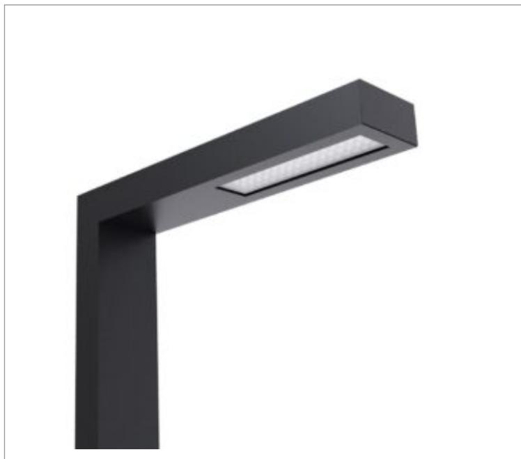
Pétala retangular, 50W 3000K IRC>80. Corpo em alumínio. Acabamento Branca, Preta ou Especial. Controle óptico principal através de lente fecho Street. Luminária grau de proteção IP-65. Driver corrente constante Liga/Desliga, Triac, 1-10V ou Dali (consultar condições). Tensão de trabalho 220V ou Bivolt.
