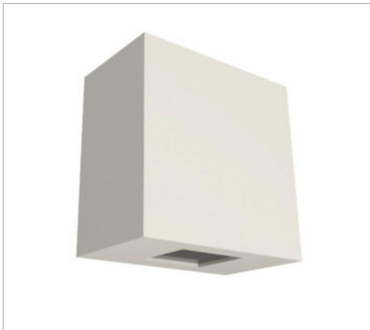
Luminária quadrada arandela iluminação direta e indireta, 8W 4000K IRC>80. Corpo em alumínio. Acabamento Branca, Preta ou Especial. Controle óptico principal através de facho Difuso Direto e Indireto. Luminária grau de proteção IP-20ou65 (consultar condições). Driver corrente constante Liga/Desliga Tensão de trabalho 127V ou 220V.
