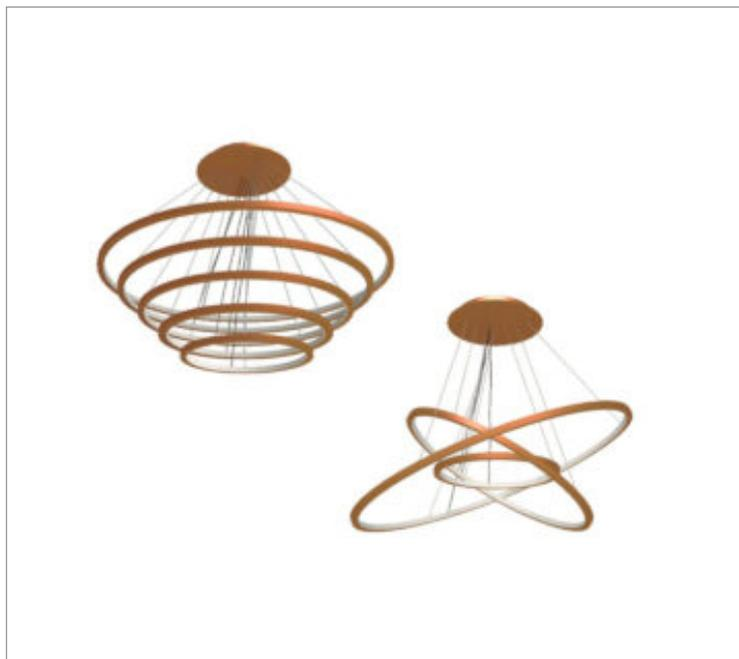
Luminária circular pendente iluminação direta e indireta, 9W 2700K IRC>95. Corpo em alumínio. Acabamento Branca, Preta ou Especial. Controle óptico principal através de facho difuso. Luminária grau de proteção IP-20. Driver corrente constante Liga/Desliga, Triac, 1-10V ou Dali (consultar condições). Tensão de trabalho 220V ou Bivolt.
