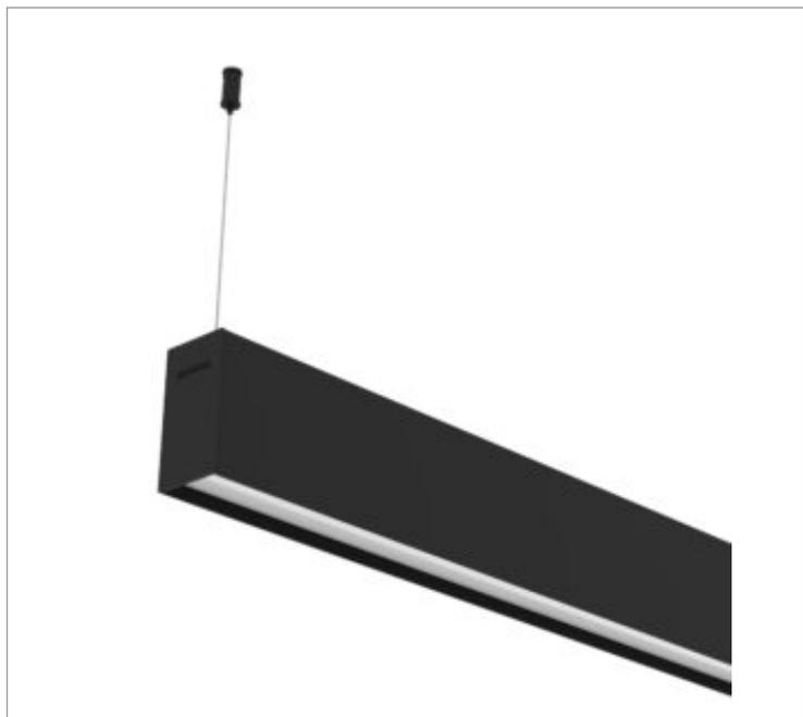
Luminária linear pendente iluminação direta, 25Wm 5000K IRC>80. Corpo em alumínio. Acabamento Branca, Preta ou Especial. Controle óptico principal através de difusor em poliestireno translúcido. Luminária grau de proteção IP-20. Driver corrente constante Liga/Desliga, Triac, 1-10V ou Dali (consultar condições). Tensão de trabalho 220V ou Bivolt.
