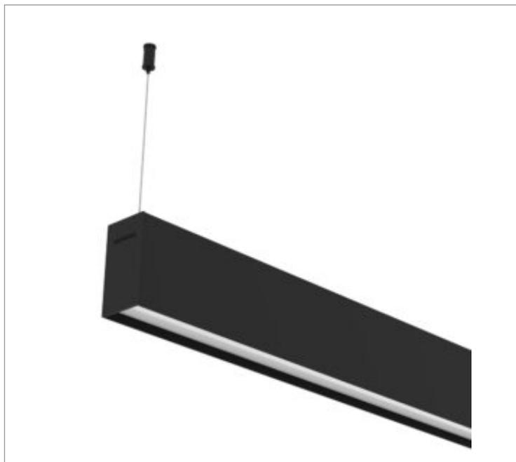
Luminária linear pendente iluminação direta, 25Wm 2700K IRC>80. Corpo em alumínio. Acabamento Branca, Preta ou Especial. Controle óptico principal através de difusor em poliestireno translúcido. Luminária grau de proteção IP-20. Driver corrente constante Liga/Desliga, Triac, 1-10V ou Dali (consultar condições). Tensão de trabalho 220V ou Bivolt.
