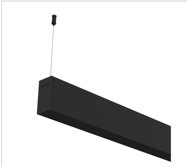
Luminária linear pendente iluminação indireta, 15Wm 3000K IRC>80. Corpo em alumínio. Acabamento Branca, Preta ou Especial. Controle óptico principal através de difusor em poliestireno translúcido. Luminária grau de proteção IP-20. Driver corrente constante Liga/Desliga, Triac, 1-10V ou Dali (consultar condições). Tensão de trabalho 220V ou Bivolt.
