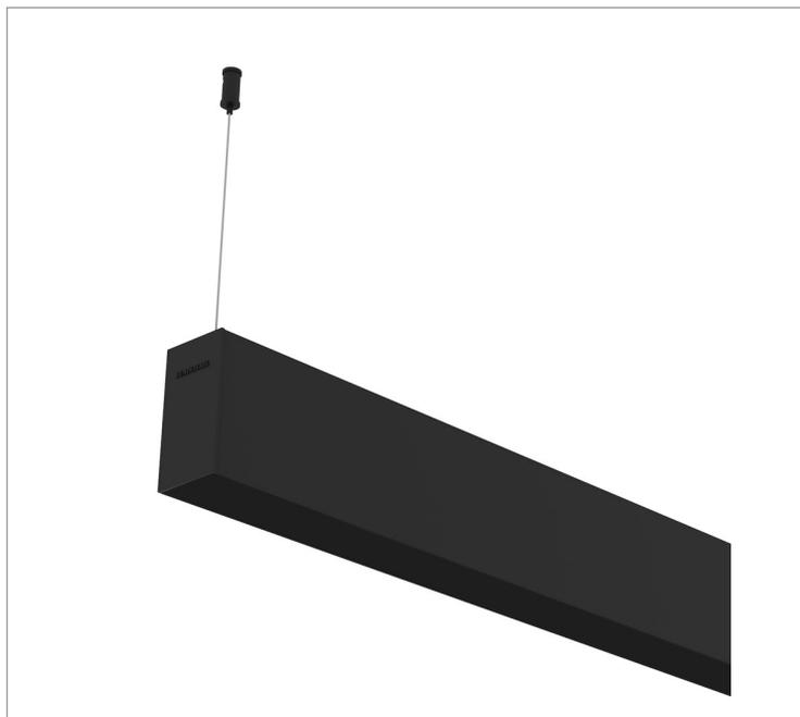
Luminária linear pendente iluminação indireta, 37Wm 5000K IRC>80. Corpo em alumínio. Acabamento Branca, Preta ou Especial. Controle óptico principal através de difusor em poliestireno translúcido. Luminária grau de proteção IP-20. Driver corrente constante Liga/Desliga, Triac, 1-10V ou Dali (consultar condições). Tensão de trabalho 220V ou Bivolt.
