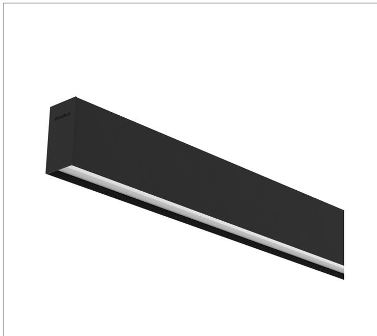
Luminária linear de sobrepor, 25Wm 2700K IRC>80. Corpo em alumínio. Acabamento Branca, Preta ou Especial. Controle óptico principal através de difusor em poliestireno translúcido. Luminária grau de proteção IP-20. Driver corrente constante Liga/Desliga, Triac, 1-10V ou Dali (consultar condições). Tensão de trabalho 220V ou Bivolt.
