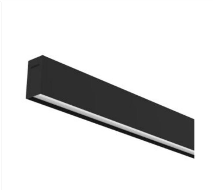
Luminária linear de sobrepor, 25Wm 3000K IRC>80. Corpo em alumínio. Acabamento Branca, Preta ou Especial. Controle óptico principal através de difusor em poliestireno translúcido. Luminária grau de proteção IP-20. Driver corrente constante Liga/Desliga, Triac, 1-10V ou Dali (consultar condições). Tensão de trabalho 220V ou Bivolt.
