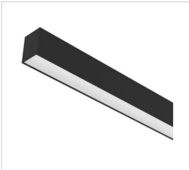
Luminária linear arandela iluminação direta, 15Wm 3000K IRC>95. Corpo em alumínio. Acabamento Branca, Preta ou Especial. Controle óptico principal através de difusor em acrílico translúcido. Luminária grau de proteção IP-20ou65 (consultar condições). Driver corrente constante Liga/Desliga, Triac, 1-10V ou Dali (consultar condições). Tensão de trabalho 220V ou Bivolt.
