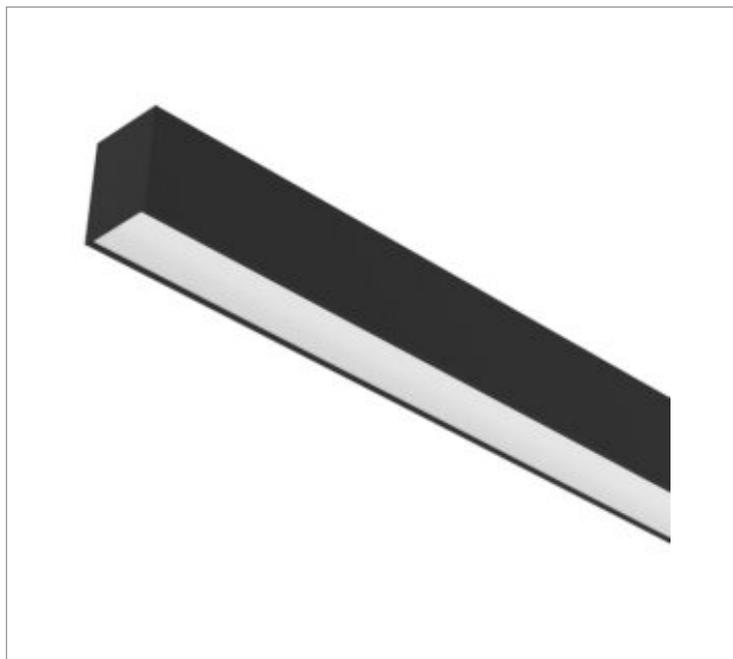
Luminária linear arandela iluminação direta, 37Wm 3000K IRC>80. Corpo em alumínio. Acabamento Branca, Preta ou Especial. Controle óptico principal através de difusor em acrílico translúcido. Luminária grau de proteção IP-20ou65 (consultar condições). Driver corrente constante Liga/Desliga, Triac, 1-10V ou Dali (consultar condições). Tensão de trabalho 220V ou Bivolt.
